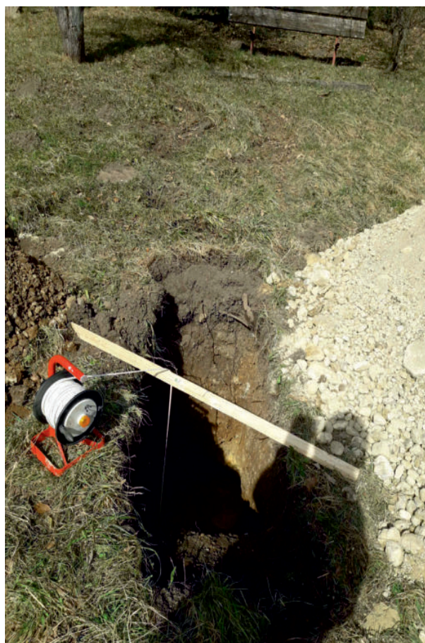
Foto 4: Sickerversuch im SG 2
