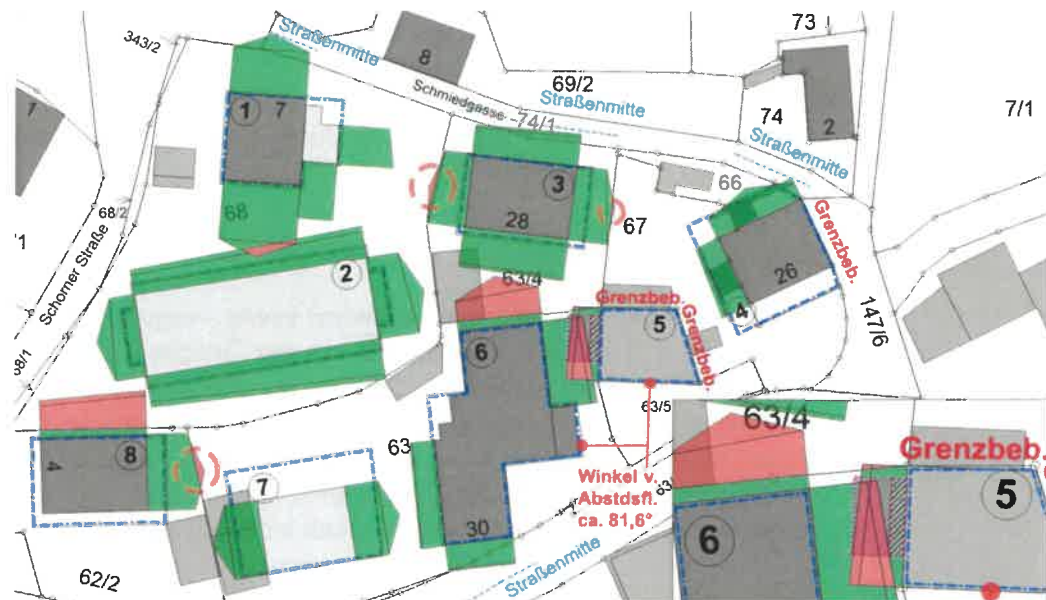
Abb. 9: Prüfung ausgewählter Abstandsflächen der Hauptbaukörper gem. AFS ( H = 0,65 ) im Plangebiet (grün: Abstandsfläche liegt auf Baugrundstück; rot: Abstandsflächen liegen auf benachbartem Grundstück bzw. überlappen sich) inkl. Detail zu Abstandsflächen einer Außentreppe (Außentreppe: violett schraffiert; Abstandsfl.: violette Fläche), ohne Maßstab, Quelle Hintergrundkarte: Flurkarte der Bayerischen Vermessungsverwaltung, Stand 10/2019
