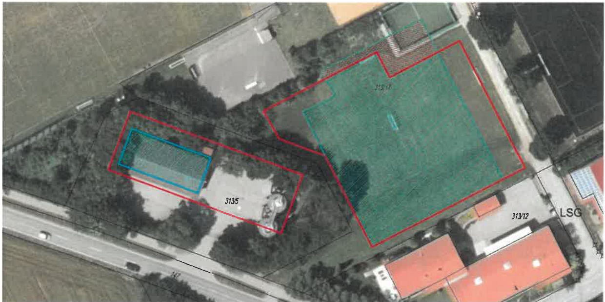
Abb. 3 Aktuelle Nutzung im Planungsgebiet sowie aktuell festgesetztes (hellblau) und geplantes (rot) Baufenster
